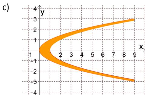
Im Plan links ist der Längsschnitt eines kleinen Glöckchens dargestellt, welches aus Bronze gegossen werden soll. Die begrenzenden Kurven sind die Graphen von  $y = \pm\sqrt{x}$  respektive  $y = \pm\sqrt{x-1}$ ; die Einheiten sind Zentimeter. Welches Volumen an Bronze wird für diesen Guss benötigt?
