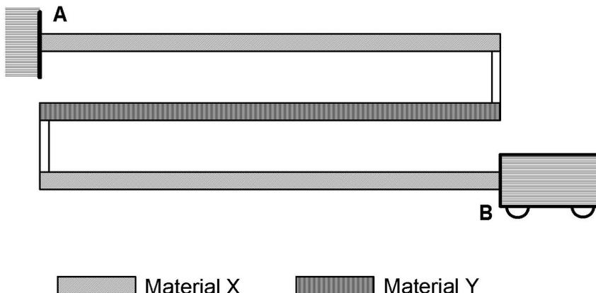
Das skizzierte Gebilde besteht aus 3 gleich langen horizontalen Stäben und ist bei A fest eingespannt. Der Wagen bei B soll sich bei einer Temperaturänderung nicht bewegen. Um das zu erreichen, muss man Materialien mit geeigneten Ausdehnungskoeffizienten wählen.
