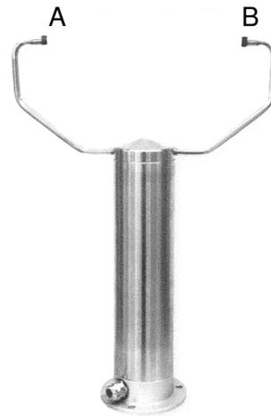
Es weht ein kräftiger Wind. Eine Messung ergibt:  $t_{AB} = 590 \mu\text{s}$  und  $t_{BA} = 667 \mu\text{s}$ .
