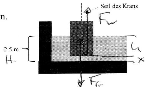
a1) Berechnen Sie numerisch die Grösse der Gewichtskraft  $F_G$  des Quaders und zeichnen Sie  $F_G$  in Figur 7 ein, beschriftet mit  $F_G$  (beachten Sie den Angriffspunkt).
