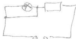
6.2 Der Widerstand von R kann zwischen  $0 \Omega$  und  $30 \Omega$  verändert werden. Bei welcher Einstellung brennt das Glühlämpchen ...
